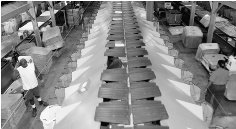
Empleados de United Parcel Service trabajan en una pequeña línea automatizada de paquetes para carga aérea en el centro de distribución de Louisville, Kentucky, que costó 1000 millones de dólares. Los paquetes (en el centro de la fotografía) se depositan automáticamente en el cubo dedicado a su destino.
