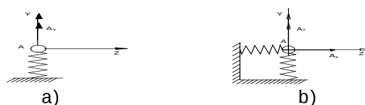
Fig. 2 Esquema de Análisis del Apoyo Articulado a) Elástico Móvil y b) Elástico Fijo.
