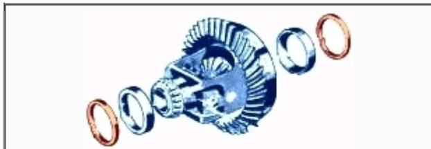
Al proceder al desmontaje de un diferencial preste especial atención a los espaciadores (coloreados en naranja en la figura superior), ya que la calibración de éstos gobiernan la distancia de acoplamiento entre la corona y el pinion central. Una colocación inadecuada de éstos puede llegar a provocar la rotura de los dientes del pinion, por lo que es recomendable marcarlos de alguna forma marcando su posición correcta antes de desmontarlos.
