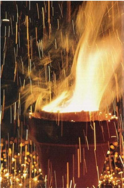
*Fig. 5. Obtención de hierro por aluminotermia.*
