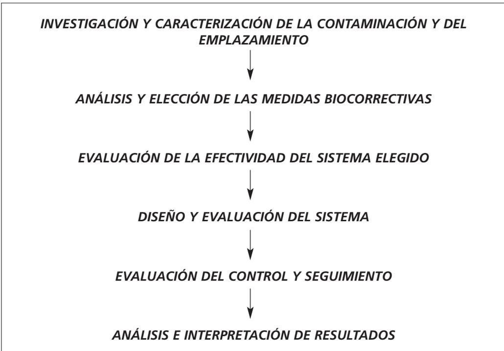
**Figura 2.** Esquema de diseño y aplicación de los sistemas de biotratamiento
