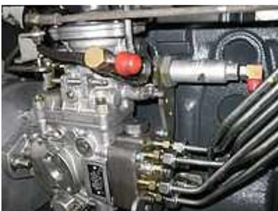
Bomba de inyección de combustible BOSCH para motor diésel.
