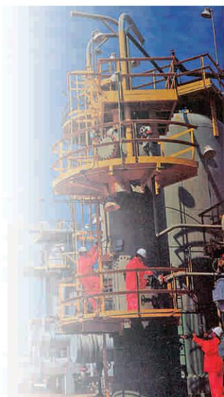
La desintegración catalítica se realiza en una columna de fraccionamiento. El proceso de desintegración llamado "cracking" o craqueo y también pirólisis, transforma moléculas grandes de hidrocarburos en otras más pequeñas según la fracción deseada.
