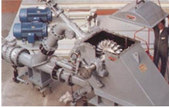
Siendo una turbina de impulso, la eficacia es alta y estable sobre la mayoría del rango del flujo. múltiples chorros proporcionan de dos a cuatro veces la potencia normal de salida para un diámetro dado de rueda.
