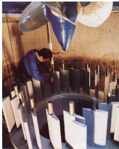
Fig. 2.16. Disposición de los álabes del distribuidor de una turbina Kaplan
