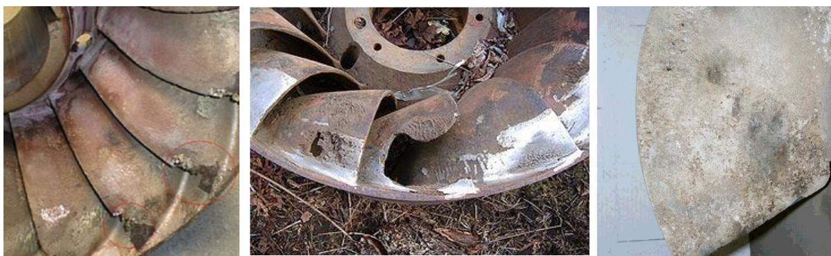
Fig. 7.1. Alabes de turbinas de reacción afectados por la cavitación.
