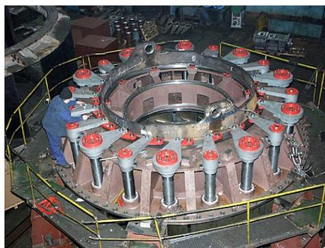
Fig. 2.11. Distribuidor de una turbina de reacción. Las bielas de accionamiento permiten la graduación del caudal que ingresa al rodete (Figura tomada de la referencia 2).
