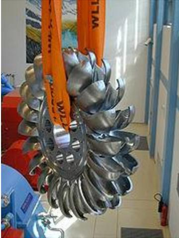
Turbina Pelton, ésta es una turbomáquina transversal de admisión parcial.
