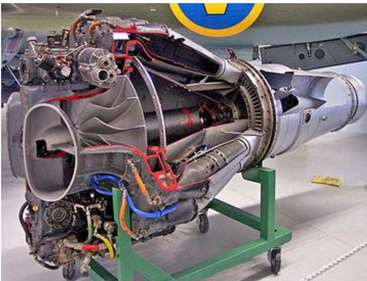
Turborreactor Rolls Royce, donde puede observarse la admisión de aire a la izquierda y el fluido que sale por los extremos del rotor hacia la cámara de combustión.
