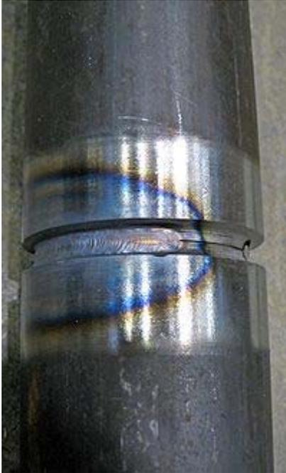
El área azul resulta de la oxidación en una temperatura correspondiente a 316 °C. Esto es una manera precisa de identificar la temperatura, pero no representa el ancho de la zona afectada térmicamente (ZAT). La ZAT es el área estrecha que inmediatamente rodea el metal base soldado.
