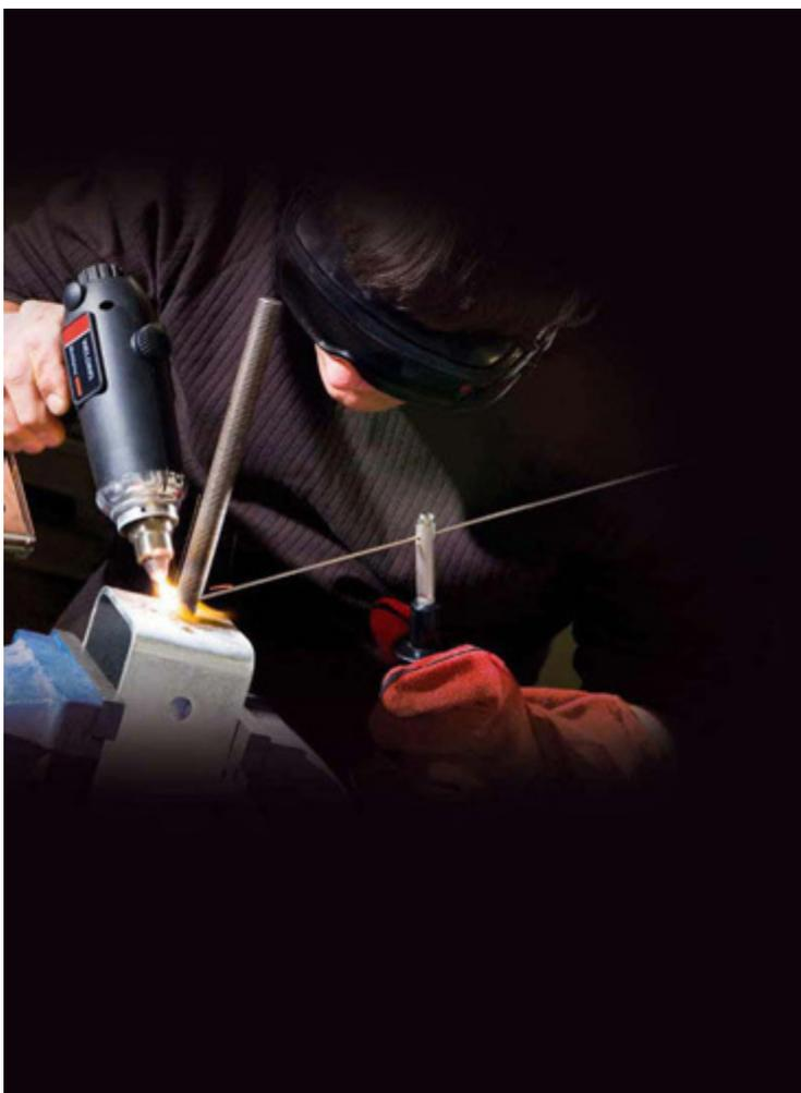
Multiplaz 3500 puede usarse para separar, raspar, perforar, calentar y fundir y ser a la vez respetuoso con el medio ambiente porque no se usan gases nocivos o venenosos como propano, acetileno, nitrógeno, que se utilizan en procesos de soldadura y corte. La atmósfera dentro del área de trabajo está enriquecida con el oxígeno que se genera cuando se usa el plasma. La compatibilidad ecológica del Multiplaz Plasmaton hace
