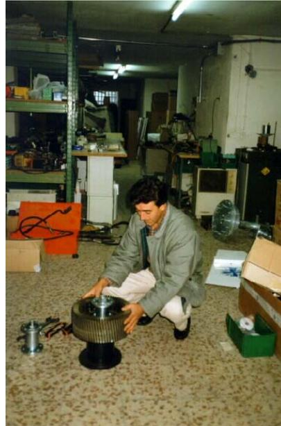
*Preparación de los paquetes de chapa magnética para bobinar*
