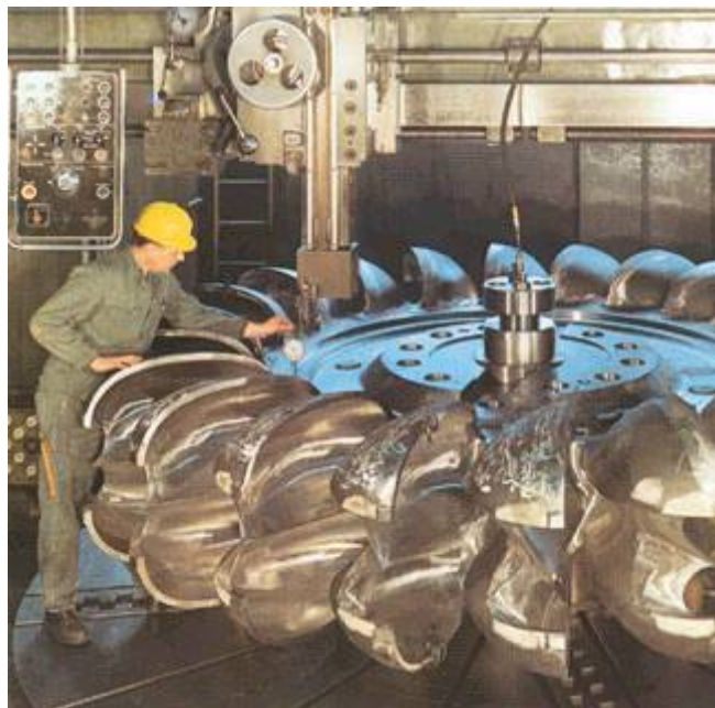
Control del rodete de una turbina Pelton vertical
