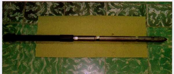
Figura 7. Ensamble: Coupling de la bomba de subsuelo – nipplesilla perforada – Memoria registradora de Presión
