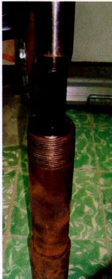
Figura 8. Verificación del ensamble dentro de la seating nipple
