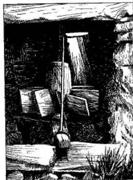
FIG.1 Rueda hidráulica horizontal primitiva.
