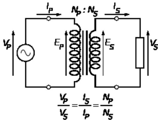
Esta particularidad se utiliza en la red de transporte de energía eléctrica: al poder efectuar el transporte a altas tensiones y pequeñas intensidades, se disminuyen las pérdidas por el efecto Joule y se minimiza el costo de los conductores.
