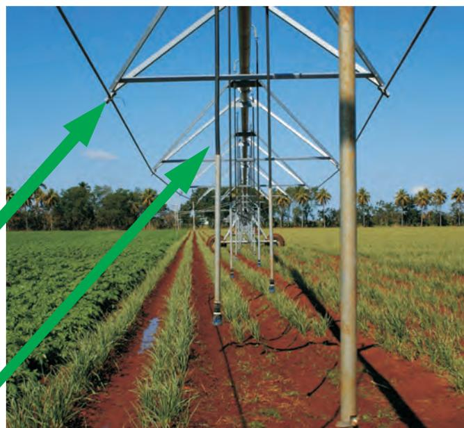
Detalle contrapeso tubular para bajantes drops que anula las oscilaciones causadas por el viento.
